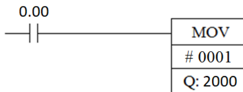
Figura 7.20 – Exemplo de Habilitação do Módulo de Entrada e Saída Analógica Setando o Bit Menos Significativo
