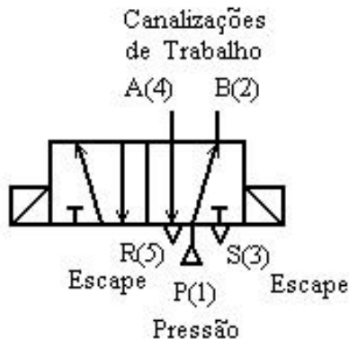
Figura 5.7 – Representação da Válvula 5/2 Vias, Acionamento por Duplo Solenoide
