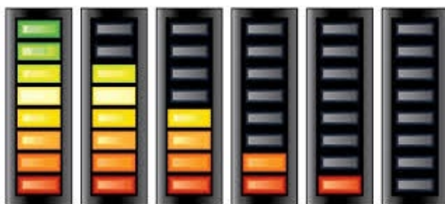
Figura 7.25 – Bargraph com 8 lâmpadas
