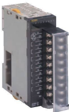
Figura 7.18 – Módulo de Entrada e Saída MAD42
