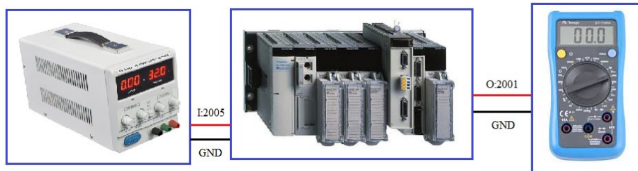
Figura 7.21 – Testando Módulo de Entrada e Saída Analógica
